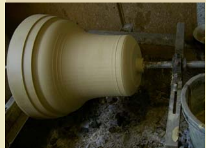
Na verwijderen van de mallen
